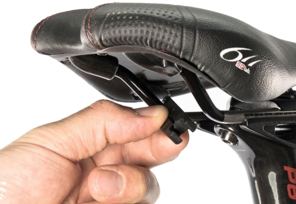
**5:** Den Halter an der gewünschten Position fixieren und mit dem beiliegenden Inbus festziehen.
